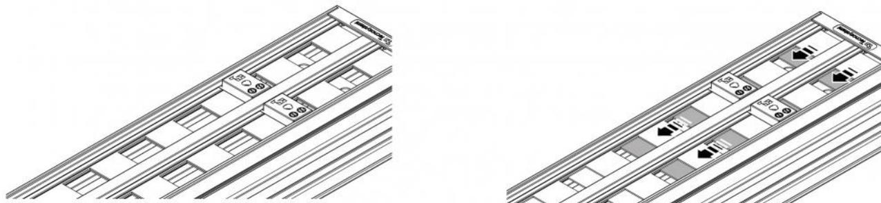
Regolare la serranda con un cacciavite da sotto il diffusore montato.
